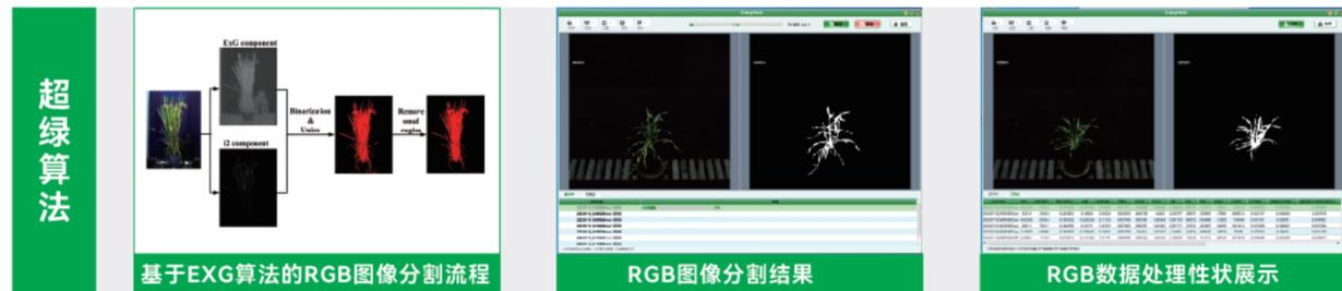
基于EXG算法的RGB图像分割流程
